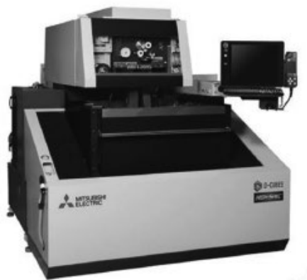
图 2 三菱 MV1200S 线切割放电加工机
