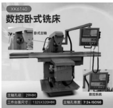
图 1 XK6140 数控卧式铣床
