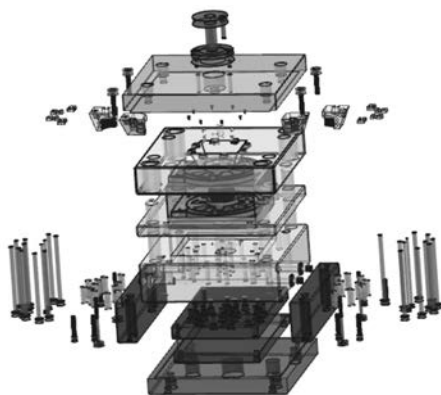
图5 塑件注射成型模具总装图(爆炸图)
