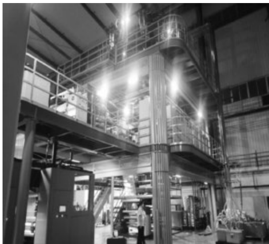
图 10 生产中的 11 层共挤下吹先进装备
