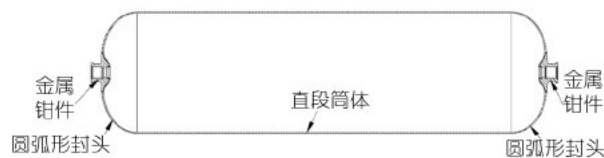
图 1 IV 型储氢瓶滚塑内胆结构
